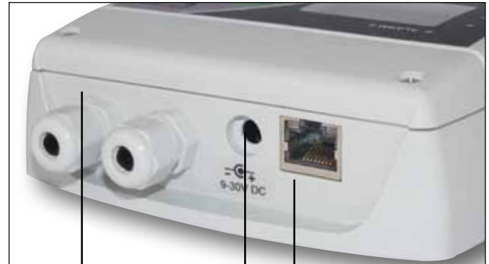
Geheugenopslag tot 1.000 meetwaarden Aansluiting voor de voedingsadapter RJ-45-aansluiting voor koppeling met het ethernet/LAN-netwerk
